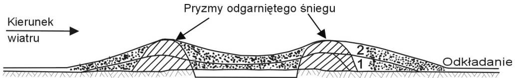
Rys.6. Nawiewanie i odkładanie się śniegu na drodze w terenie płaskim
